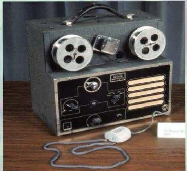
Magnetófono de alambre. La grabación se realizaba en un alambre que era magnetizado por la cabeza grabadora
